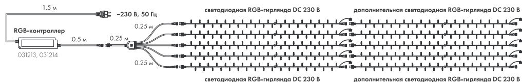
Рисунок 3. Схема подключения светодиодных гирлянд суммарной мощностью не более 455 Вт
